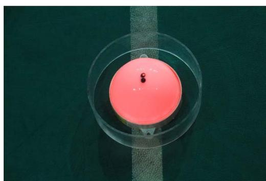
各部分尺寸如下：信标灯外径大约 10cm，亚克力透明罩外径 16cm，高度 5cm，黑圈使用双胶纸印刷制作，外径 20cm，内径 16cm。竞赛中，以亚克力透明罩是否有位移判断是否违例（进入黑圈），以信标灯是否有位移判断是否撞灯。
